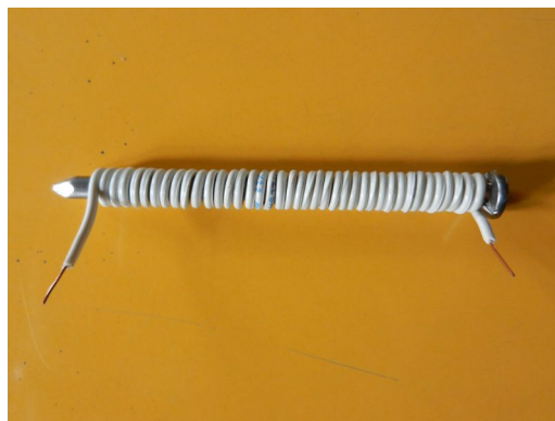
Abb. 6: Ein einfacher Elektromagnet aus Nagel und isoliertem Draht
