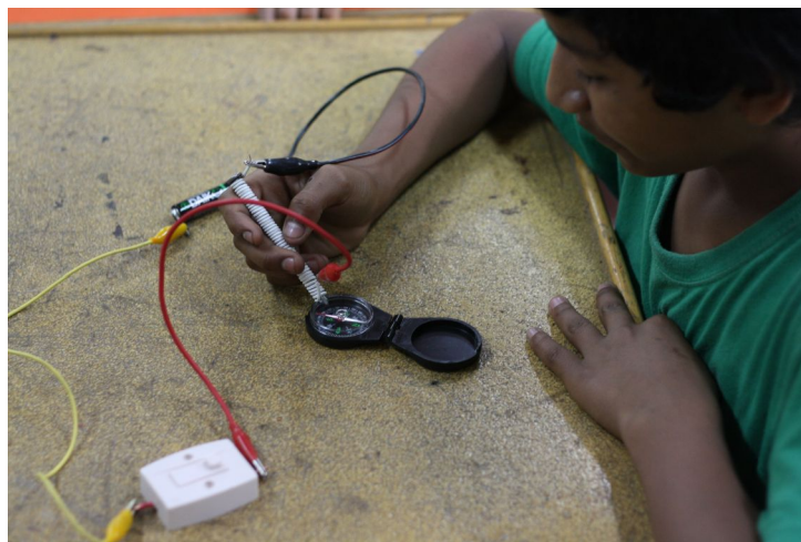
Abb. 7: Wird der Schalter gedrückt, reagiert die Kompassnadel auf den Elektromagneten.
